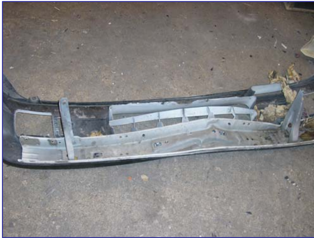
Parachoque de PP con un gran refuerzo interno de metal.
