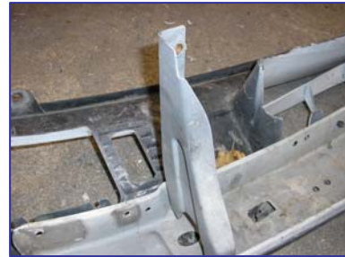
Parachoque de PP con un gran refuerzo interno de metal.
