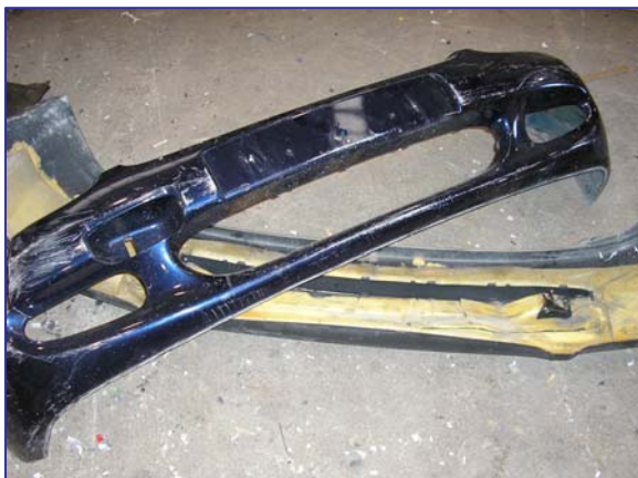
Parachoques rígidos con interior relleno de espuma.
