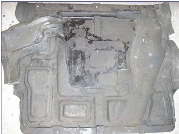
Cubre motor (bajos) en PP+FV con aislante acústico adhesivado, además de una clara acumulación de grasa.
