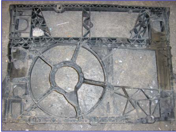
Ejemplos de soportes delanteros de radiador en PP + FV.
