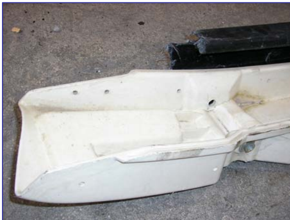
Refuerzos interiores de parachoques de PBT+FV (blanco) y PP+FV (negro).
